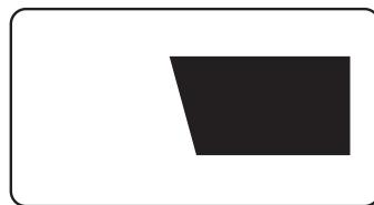
刀片尖刃不做任何处理 No processing of the insert sharp edge
